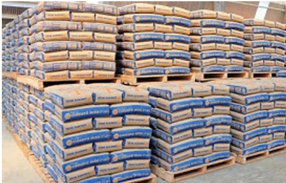
Foto 2: Empilhamento de Cimento paletizada.
