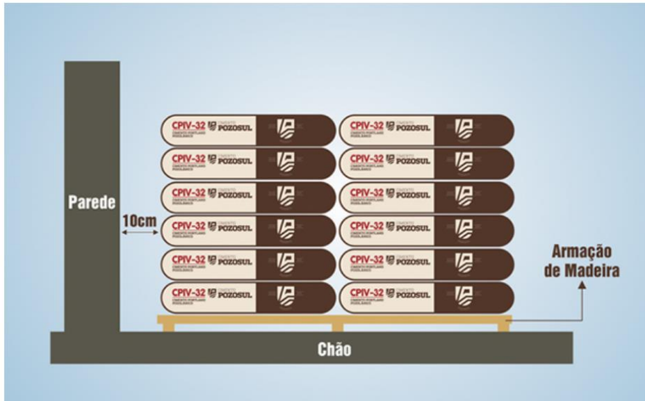
Foto 1: Empilhamento de Cimento.
