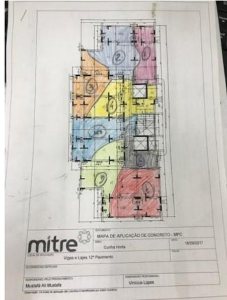
Imagem 19 - Exemplo de mapeamento do concreto
