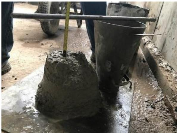
Imagem 13 - Após o molde do corpo de prova, deve ser realizada a extração, verificando o abatimento, com auxílio de uma trena, em relação ao tronco de cone original.
