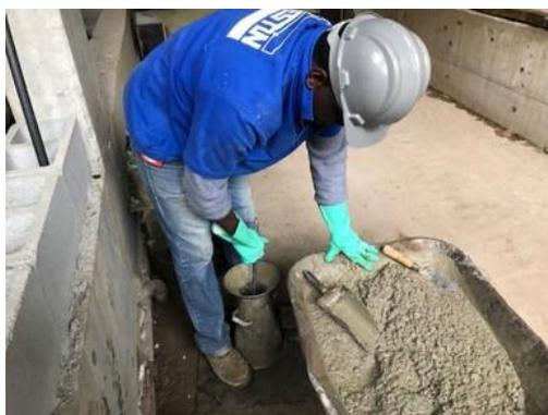
Imagem 4 - Adensamento do corpo de prova
