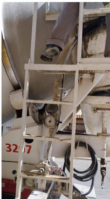
Imagem 3 - A quantidade adicionada deve ser controlada pelo medidor presente na betoneira
