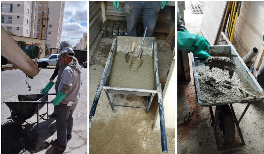
**Imagem 7 - Preparação do Concreto para o Slump Test**
