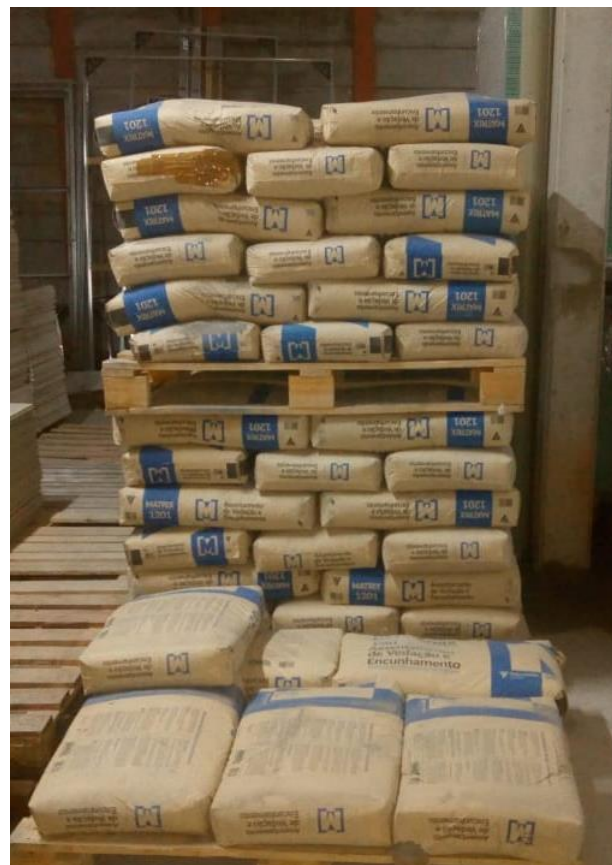
Foto 2: Empilhamento de Argamassa paletizada.
