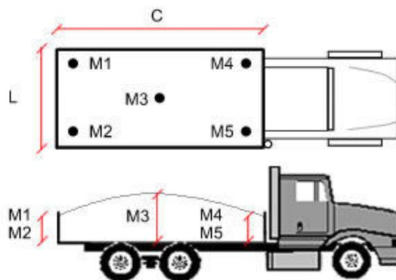
Deverá ser marcado o ponto do topo da areia na barra de aço e medido a altura do furo pela haste
